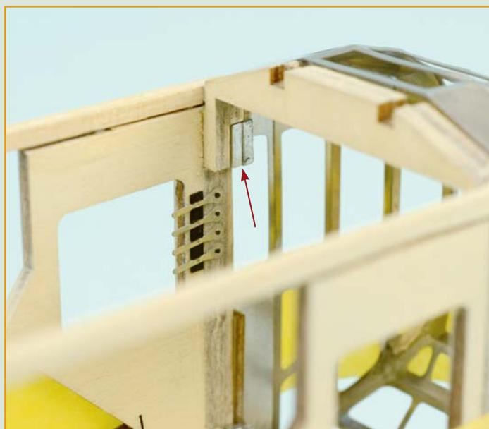
**48** Магниты второго ряда должны точно войти во внутренние углы первого фюзеляжного шпангоута. Убедившись, что детали прилегают ровно, плотно и без перекосов, нанесите аппликатором капли моментального клея в стыки между фюзеляжными магнитами и шпангоутом. Клея должно быть немного, чтобы не допустить склеивания магнитов друг с другом.
