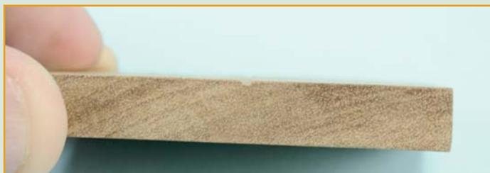
**СОВЕТ.** Возьмите прямоугольный и плоский брусок твердого дерева и сделайте в нем надфилем поперечный пропил шириной и глубиной 1 мм.
