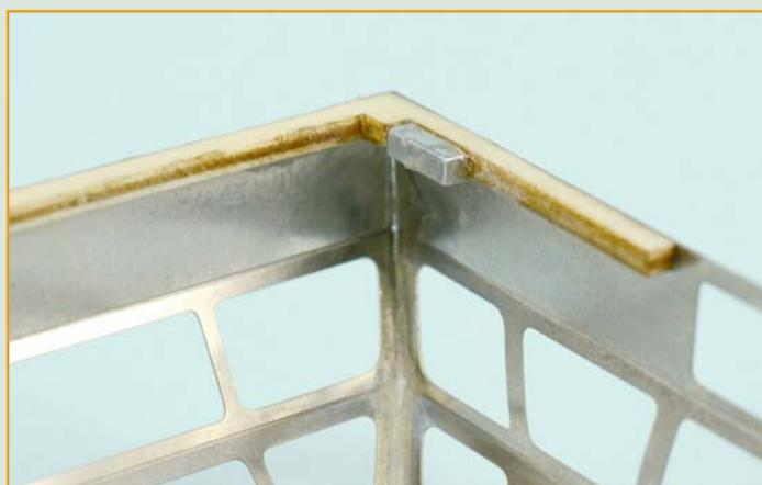
**45** Передняя часть кабины вашей модели будет съемной, соединенной с фюзеляжем на магнитах. Возьмите четыре магнетика, полученные в этой посылке, и вклейте их заподлицо в прямоугольные вырезы по углам фанерной окантовки каркаса.
