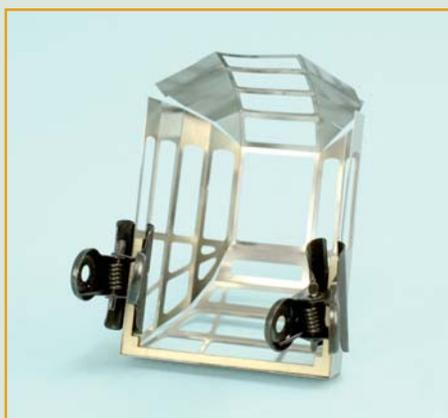
**38** Теперь приклейте короткие боковые стороны деревянной рамки к краям боковых панелей каркаса кабины, также используя зажимы для выравнивания и фиксации.
