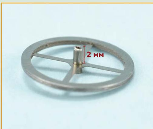
**20** Вклейте полученный отрезок в центральное отверстие штурвальной втулки таким образом, чтобы выступающий конец имел длину 2 мм.
