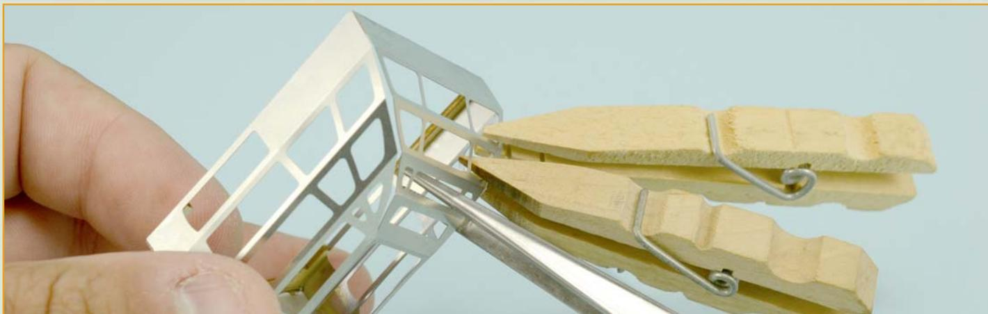
**40** Как бы вы ни старались, выгибая деталь Н7, между ее боковыми стенками наверняка остались небольшие зазоры. Закройте их, плотно прижав края стенок друг к другу зажимами и пинцетом, а затем промажьте стыки изнутри моментальным клеем. Делайте это аккуратно, стараясь не помять тонкие перемычки, а после полного высыхания клея снимите зажимы.
