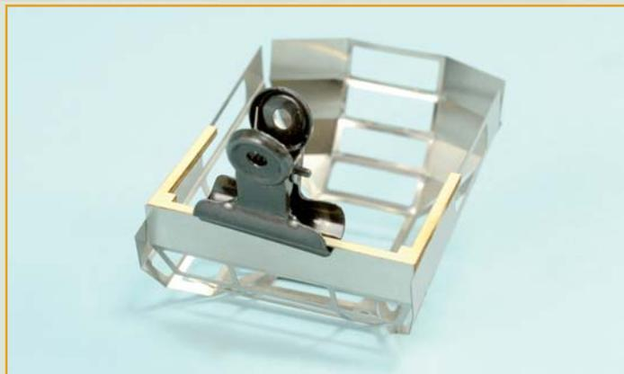
**36** Извлеките деталь 3 из фанерной заготовки. Используя для фиксации небольшой пружинный зажим или прищепку, аккуратно и ровно приклейте средний длинный фрагмент к краю детали Н7, как показано на снимке.
