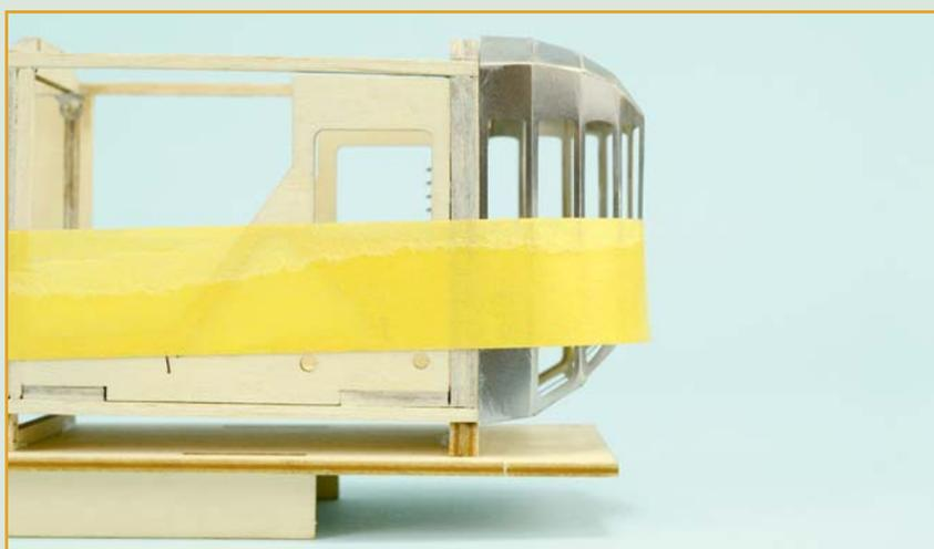
**47** Присоедините каркас передней части кабины к каркасу фюзеляжа и зафиксируйте его отрезком бумажной клейкой ленты.
